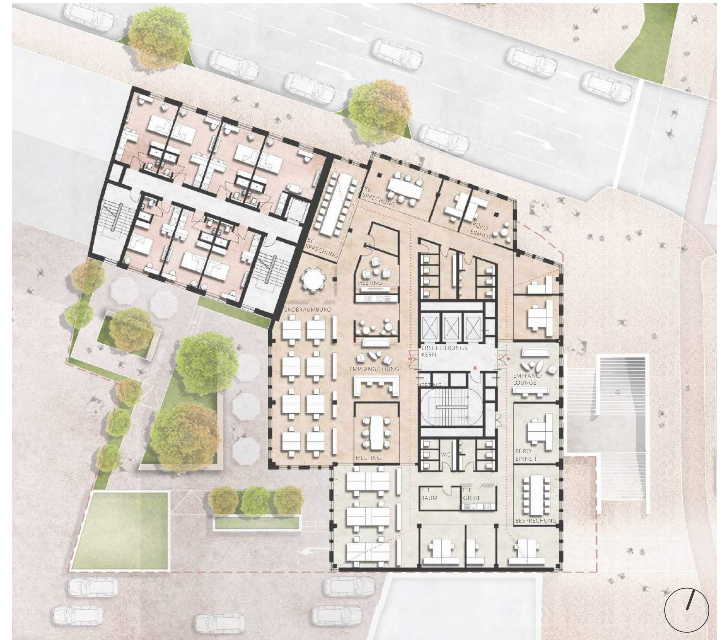
GRUNDRISS 1.-5.OG SERVICED APARTEMENTS + 1.-4.OG BÜRO M1:200
