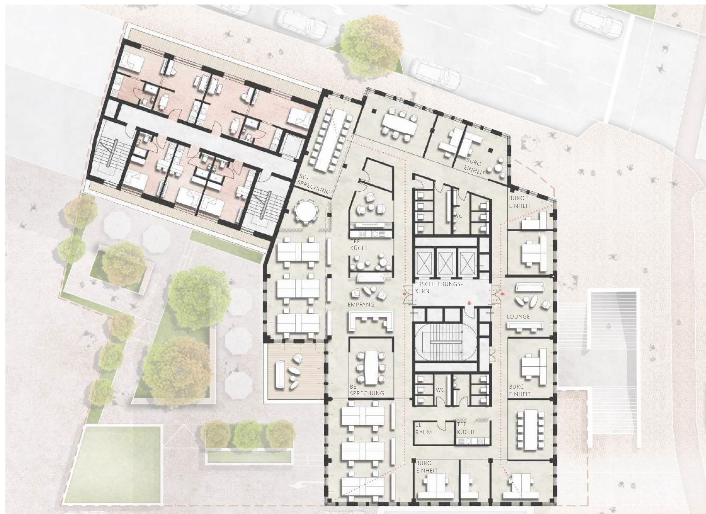
GRUNDRISS 6.OG SERVICED APARTEMENTS + 5.-7.OG BÜRO M1:200
